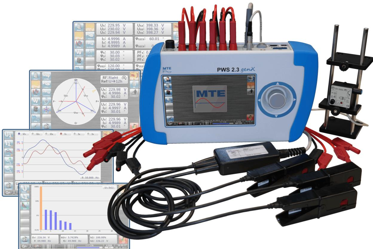
L'unité PWS 2.3 genX est un compteur étalon électronique, triphasé, portable. Il est utilisé pour vérifier des compteurs monophasés ou triphasés sur site. Le PWS 2.3 genX offre la possibilité de contrôler tous paramètres d'un compteur, de son installation et de ces transformateurs de tension (TT) et de courant (TC).
